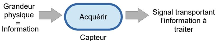
Le capteur est un composant qui permet de mesurer une grandeur physique pour **acquérir une information** et la **transporter par un signal**.
