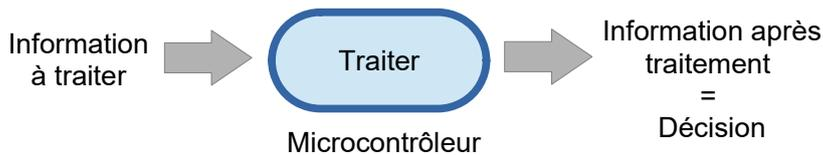
Le microcontrôleur est un composant rassemblant un **processeur pour exécuter** les instructions d'un programme et une **mémoire pour stocker** les informations.
