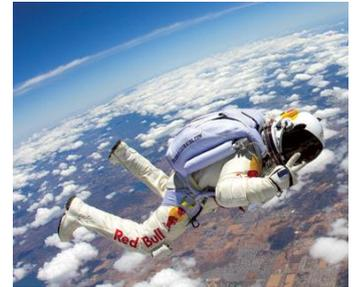
Le sac/harnais assure le maintien du parachutiste sous la voile. Il encaisse et répartit les efforts d'ouverture. On y retrouve, dans le dos, deux conteneurs : celui de la voile principale, toujours situé en bas, et celui de la voile de secours, sur la partie supérieure.
