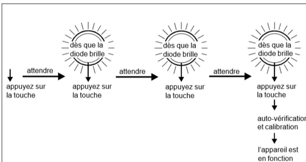
Une fois la séquence de démarrage terminée, CYPRES lance une procédure d'auto-vérification pour s'assurer qu'il fonctionne correctement. Si cette auto-vérification donne satisfaction, le système démarre. Lorsque la vitesse de descente atteint 35 m/s et que l'altitude est de 225 m, le sectionneur coupe la boucle et ouvre la voilure de secours.
