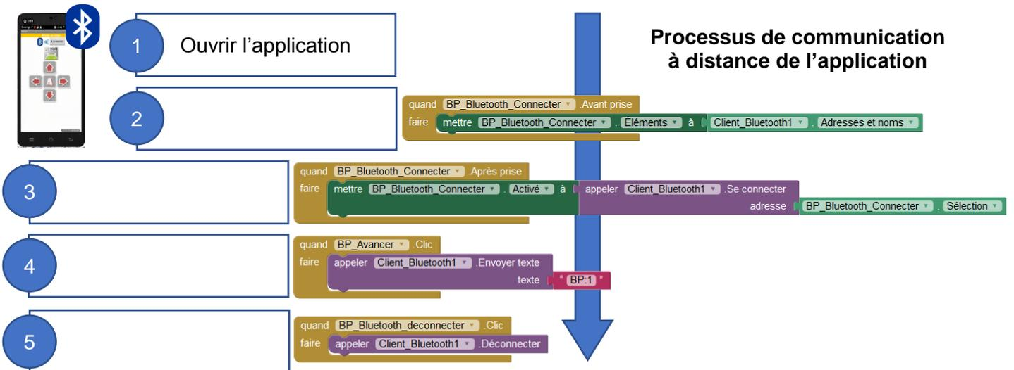
**Le fonctionnement et la structure du robot de simulation**
