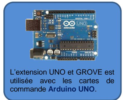
L'extension UNO et GROVE est utilisée avec les cartes de commande **Arduino UNO**.
