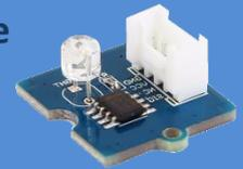
Ce capteur génère un courant électrique (A) qui dépend de la lumière reçue. Il est plus fiable et sensible que la LDR.
