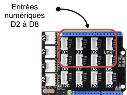
L'information est transportée par un signal électrique sous la forme d'une tension de 0V ou de 5V.
