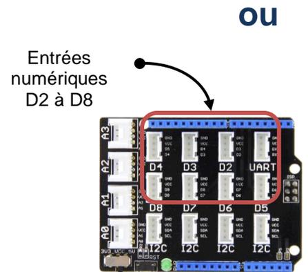
L'information est transportée par un signal électrique sous la forme d'une tension de 0V ou de 5V.
