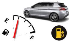
La jauge (capteur) située dans le réservoir du véhicule mesure le niveau de carburant restant qui s'affiche en permanence sur l'indicateur à aiguille du tableau de bord. Un voyant s'allume lorsque le niveau de carburant dans le réservoir du véhicule descend sous le seuil minimum.
