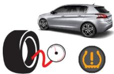
Depuis 2014, les véhicules sont équipés de capteurs de mesure en temps réel de la pression des pneumatiques sur chaque roue. Au démarrage du programme la pression des pneus de la voiture est enregistrée et le voyant s'éteint s'il était allumé. Lorsqu'une baisse de pression de plus de 20% est détectée sur un pneumatique, le voyant d'alerte s'allume.
